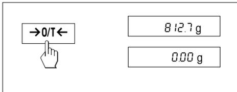
Les balances METTLER TOLEDO **DeltaRange** disposent d'une plage fine mobile, caractérisée par une résolution dix fois plus élevée. Dans cette plage, une décimale supplémentaire apparaît toujours sur l'affichage.
