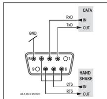
Chaque balance B-S est équipée d'une interface RS232C pour le raccordement à un périphérique (par exemple une imprimante ou un PC à l'aide d'un connecteur mâle 9 contacts). Procédez à l'adaptation à l'autre appareil dans le menu (chapitre 4.3.10 – 4.3.15).
