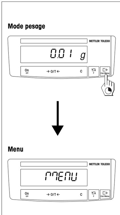
Les balances séries B disposent de deux niveaux de commande: le **mode pesage** et le **menu**. La fonction des touches dépend du niveau de commande et de la durée de pression sur la touche.
